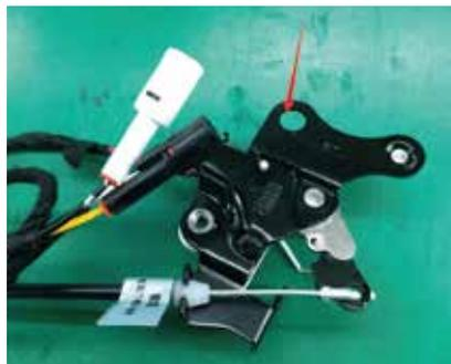
8.在原车锁上安装我司支架用螺丝固定
