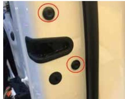
5.把原车锁头上的螺丝拆下
