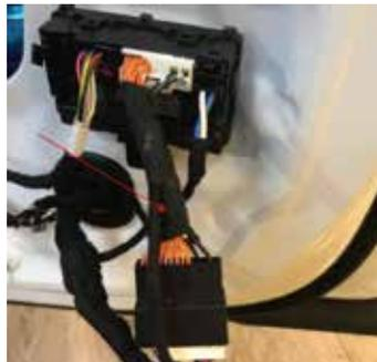
17.把原车上的电源插头拔下转插我司插头
