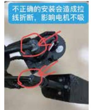
15.不正确的安装会造成拉线折断, 影响电机不吸
