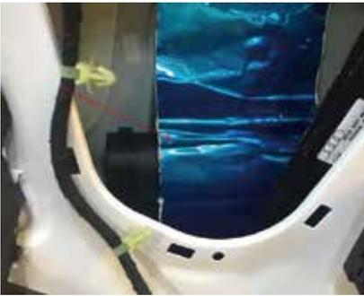
16.电机固定位置, 用我司隔音棉粘住
